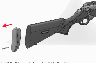
Şekil 28: Dipçik taban lastiği dipçikten ayrı.
