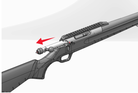
Şekil 18: Mekanizma grubu geriye çekilerek mermi, mermi yatağına alındıktan sonra tekrar ileri ve aşağı saat yönünde ittirilir.
